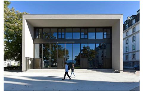
**Résolument bois.** La construction fait la part belle au bois indigène. Les 84 cadres asymétriques en mélèze lamellé-collé ont été préfabriqués en atelier à Genève avant d'être assemblés sur place comme un grand mécano. A l'intérieur, le bois, mélèze et épicéa domine également, pour les parois de séparation, les panneaux porteurs, comme pour l'agencement des loges et des bureaux.
